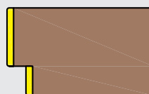
Stumpf 64 mm mit Alu-Schutzkanten und Zusatzfalz Flush hung, 64 mm with aluminum protection edge and additional rabbeted detail
