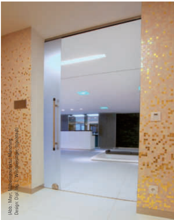
VENTURA GLAS VENTURA GLASS Schiebetür „Design b.400“ Sliding door "Design b.400" mit zusätzlicher Rollenführung (unten) with additional bottom reeldrive
