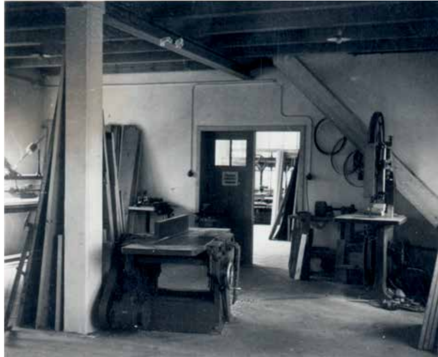
Erster Maschinenraum mit Bandsäge, Hobelmaschine, Bandschleifmaschine und Zinkenfräsgerät
